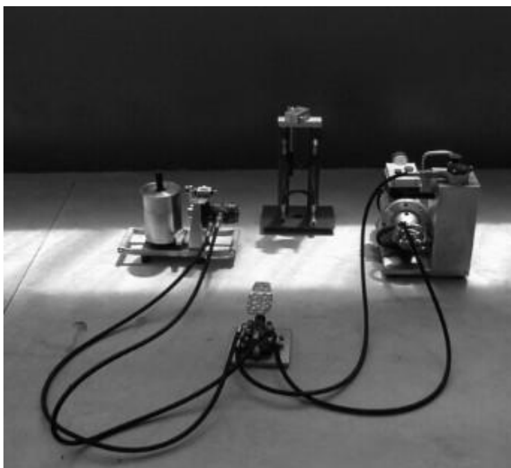
Slika 5: Dinamični penetrometer DPM 30-20
